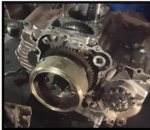
Figura 2-2. Magneto de un motor monocilíndrico
