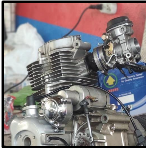
Figura 23-3. Sensor CKP adaptado al motor
