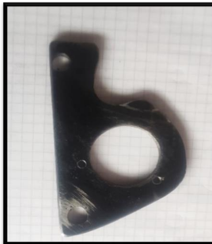
Figura 19-3. Base del sensor TPS
