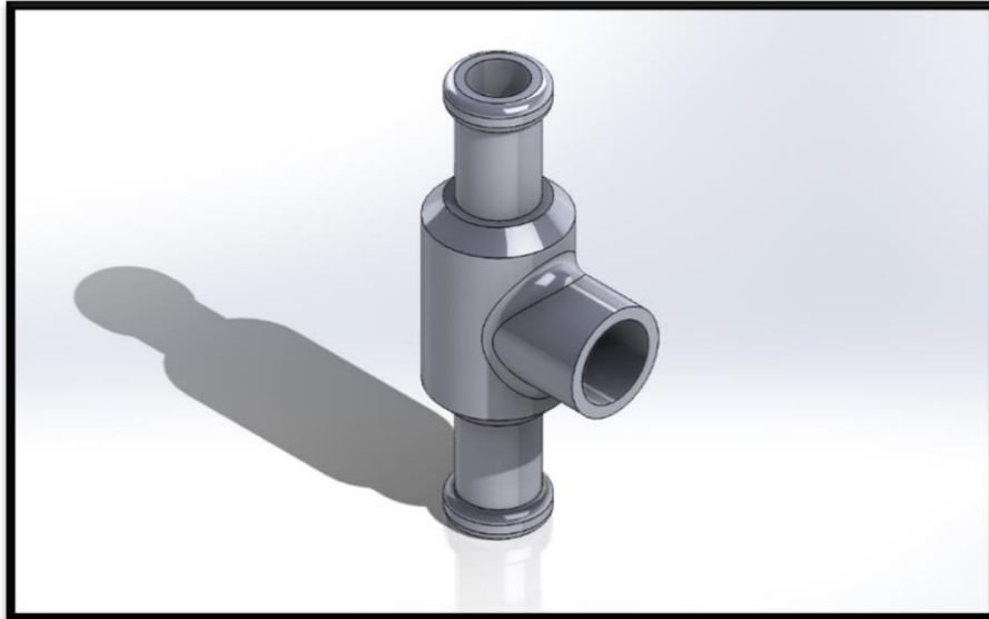
Figura 12-3. Diseño del riel de inyección
