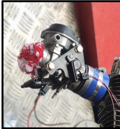
Figura 24-3. Inyector en el cuerpo de aceleración
