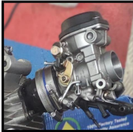
Figura 14-3. Riel de inyección adaptada a la admisión
