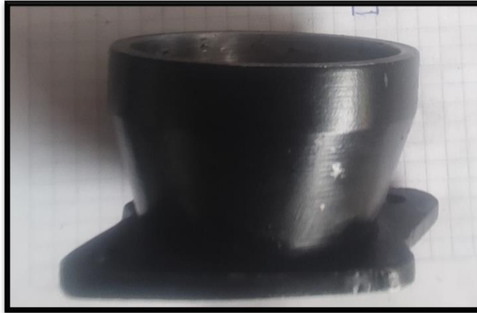
Figura 16-3. Base del cuerpo de aceleración
