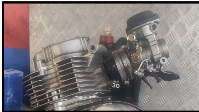
Figura 17-3. Cuerpo de aceleración adaptado al cabezote
