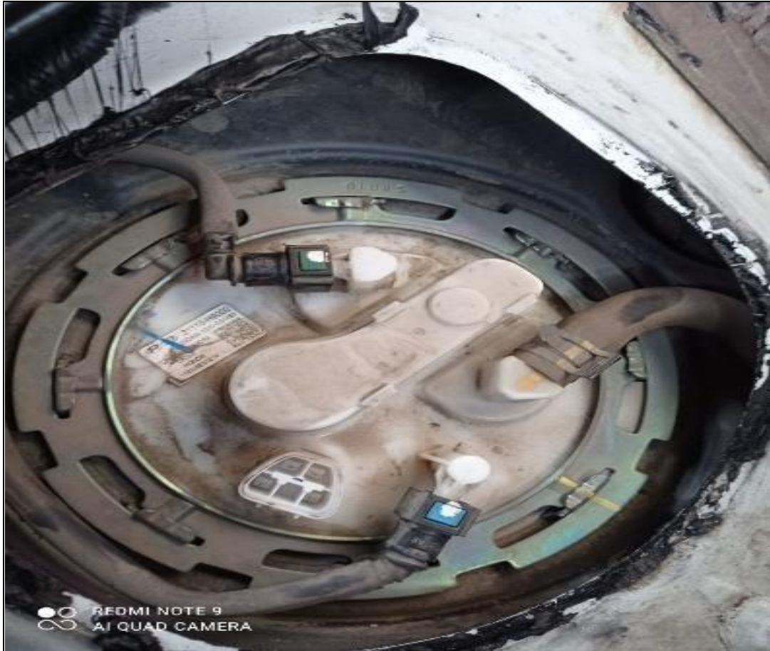
Figura 8-2: Conexiones bomba de combustible vehículo Kia
