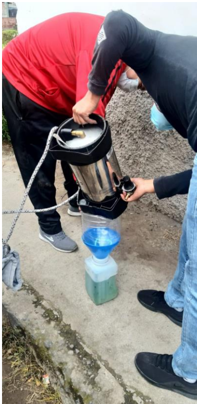
Anexo G: Medición de combustible luego de haber terminado la prueba de ruta
