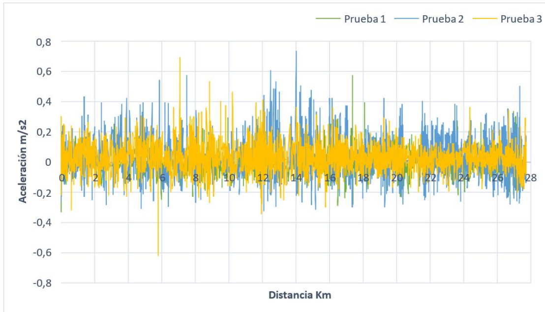
Gráfico 19-3: Aceleración vs Distancia vehículo Sa19B A/C Encendido
