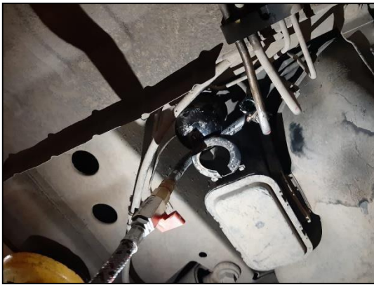
Figura 10-2: Instalación de Tanque Cánister
