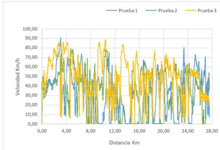
Gráfico 23-3: Velocidad vs Distancia del vehículo de prueba RIO17B con A/C Encendido
