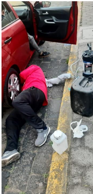
Anexo H: Desconexión entre el tanque cánister y el vehículo SA17R
