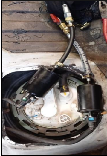
Figura 9-2: Instalación de filtros en la bomba de combustible.
