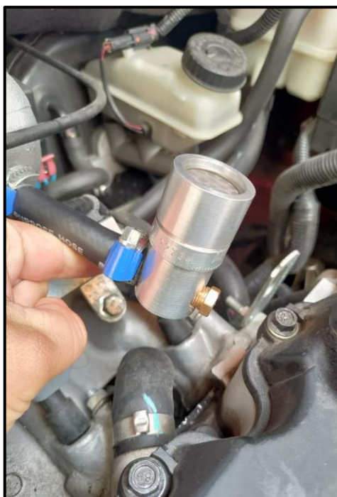
Figura 7-2. Acople de manguera y abrazaderas de presión a la válvula ecológica marclais.
