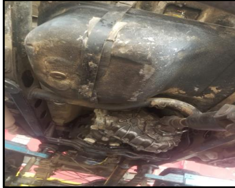
Figura 9-2. Desmontaje del tanque de combustible. Fuente: (Flores C. y Sislema A., 2021)
