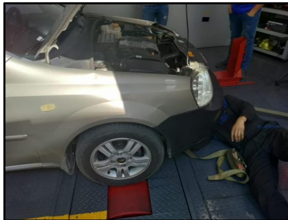
Figura 13-2. Instalación de los componentes de fijación para inmovilizar al vehículo.
