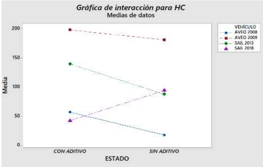
Gráfico 29-3: Interacción de medias de HC por vehículo 1, 2, 3 y 4 en los dos estados.
