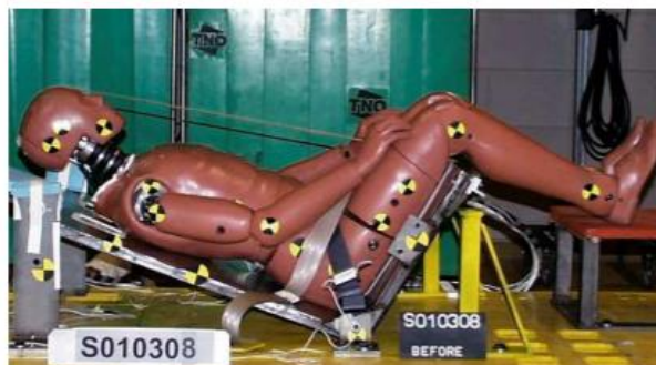
Figura 24-1. Hybrid III modificado por la FAA
