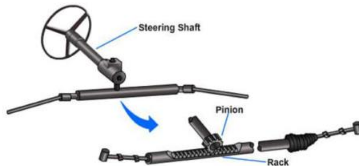
Figura 42-2. Dirección del vehículo utilizando el mecanismo de piñón -cremallera
