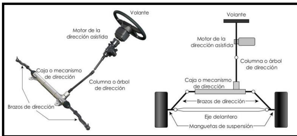
Figura 29-1. Componentes del sistema de dirección
