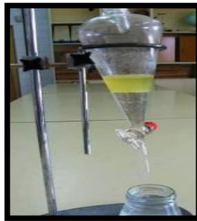
**Figura 1.3:** Embudo de separación
