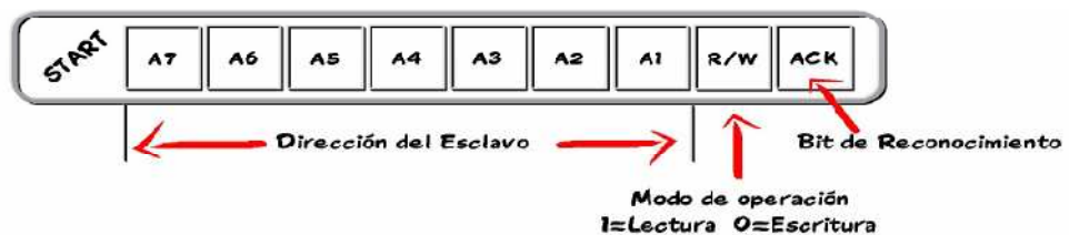
Fig. III.07. Direccionamiento de dispositivo I2C con dirección de 7 bits.
