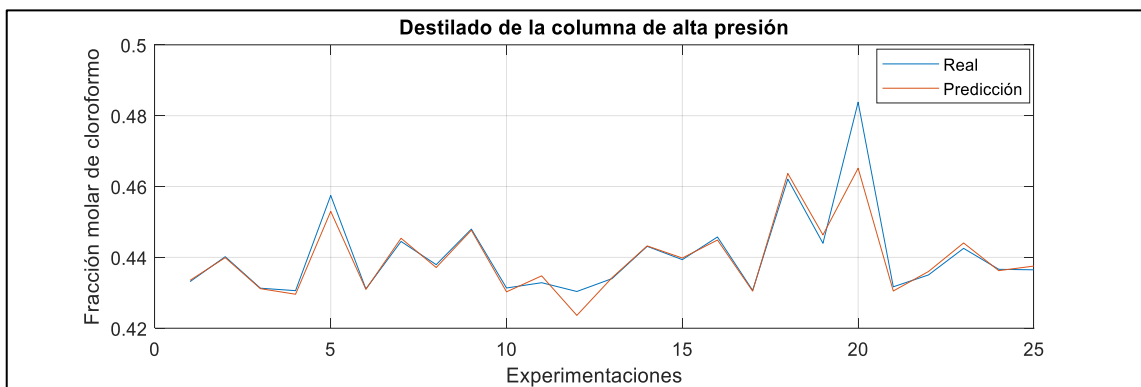
Gráfico 7-4. Fracción molar de cloroformo en destilado de la columna de alta presión
