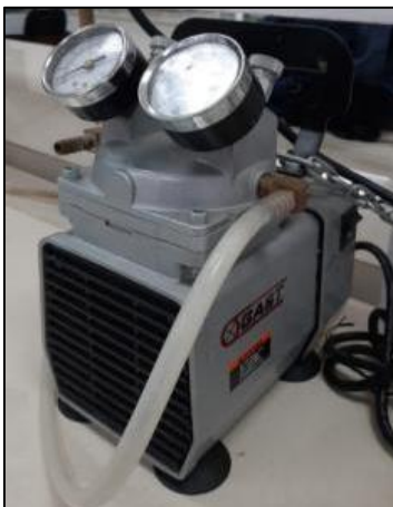
Figura 7-2. Bomba al vacío
