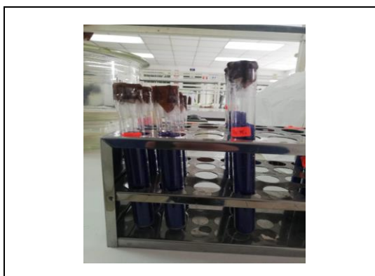
Figura 10-3: Permeabilidad al vapor de agua
