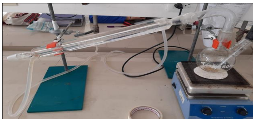
Figura 11-2: Equipo para el proceso de Glucólisis catalizada de PET Realizado por: Alvarado, M.2021.
