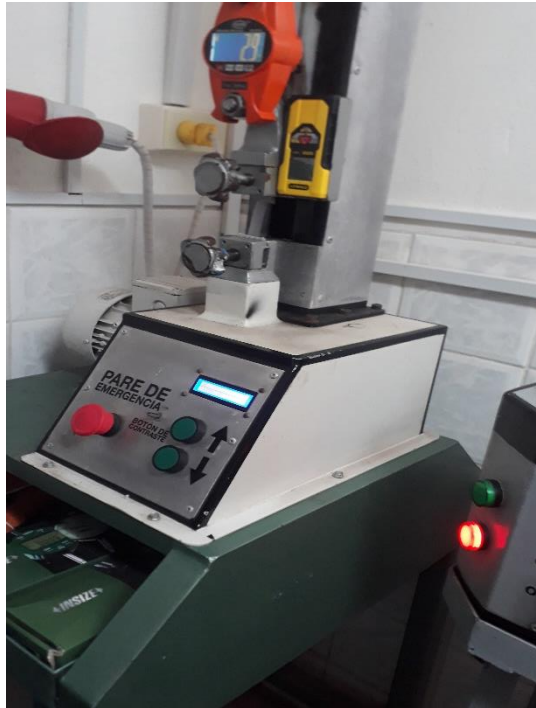
Figura 4-3: Ensayo de tracción realizado al tratamiento 2
