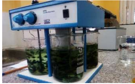
Figura 3-3: Prueba de test de jarras.
