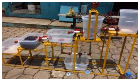
Figura 2-3: Planta piloto del tratamiento del agua industrial
