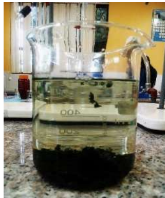
Figura 4-3: Prueba de sedimentación.
