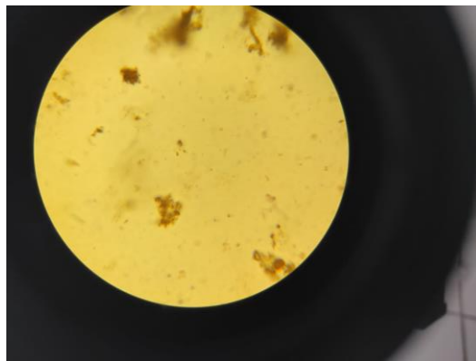
Muestra de mosto lupulado en prueba de yodo vista desde el microscopio
