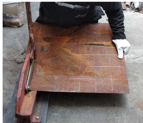
Figura 4-2. Corte de probetas metálicas.
