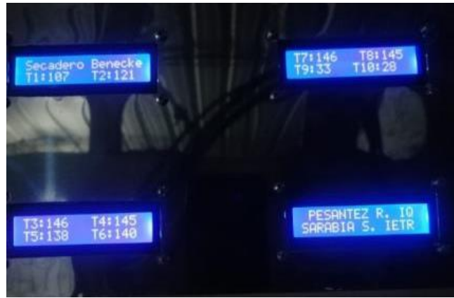
Figura 7-3: LCDs reflejando temperaturas
