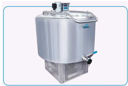
Figura 6-2. Tanque vertical de 50-300 litros
