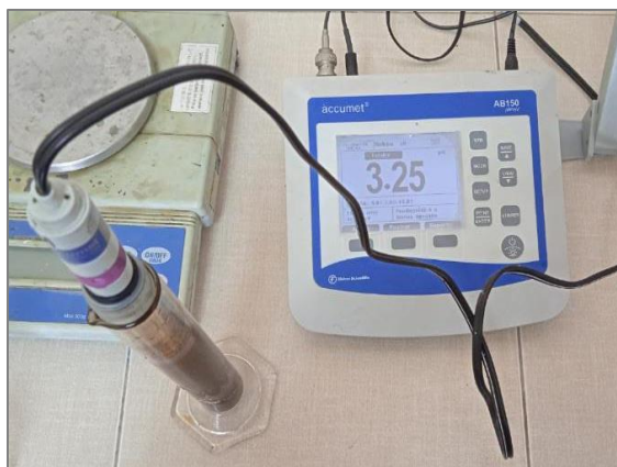
Figura 14-2. Prueba de pH al biocombustible
