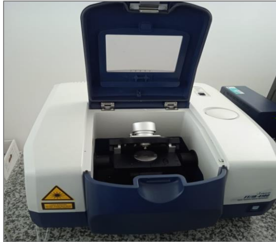
Figura 15-2. Espectroscopía infrarroja FT-IR
