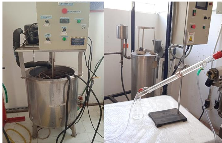
Figura 9-2. Sistema de condensación
