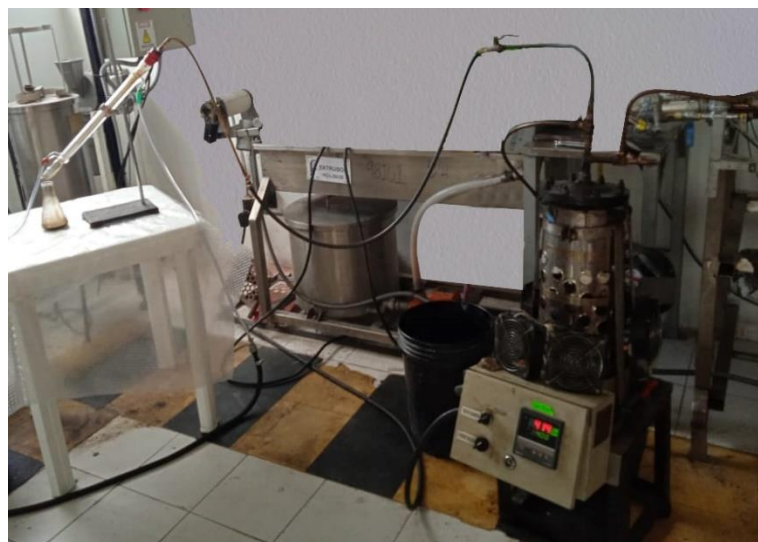
Figura 10-2. Pirólisis térmica del aserrín
