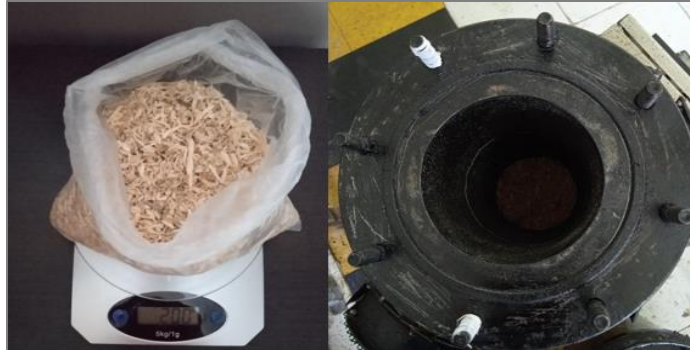
Figura 7-2. Pesaje de la muestra y colocación en el reactor
