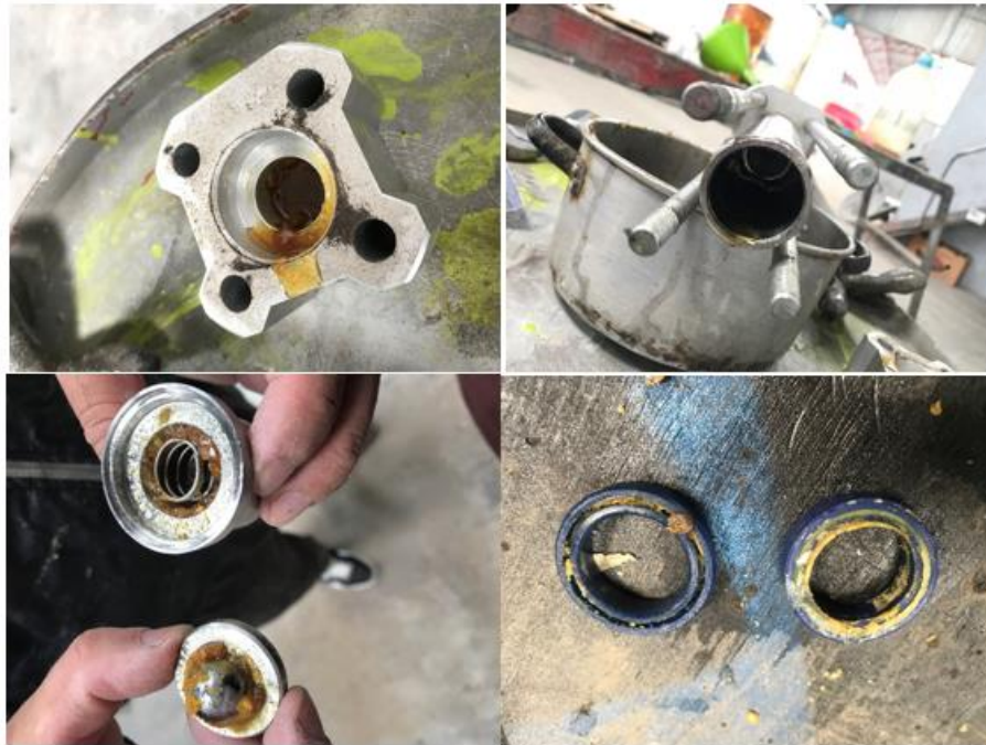
Figura 20-3. Partes defectuosas de los cilindros de presión
