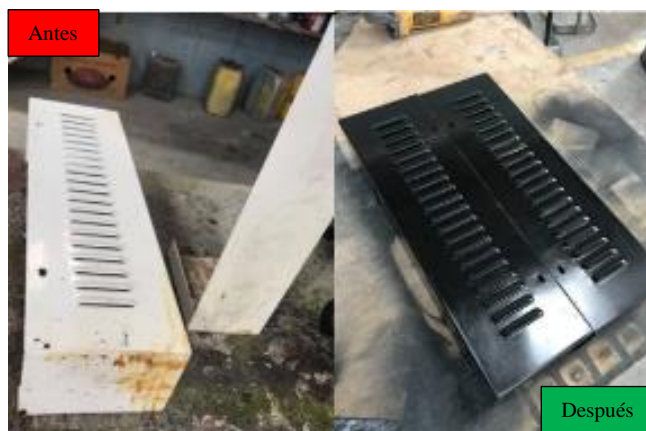
Figura 25-3. Mantenimiento de las tapas de los calentadores
