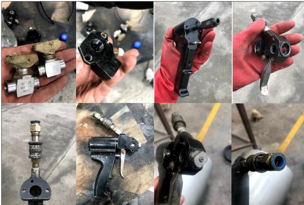
Figura 31-3. Mantenimiento de partes externas e internas de la pistola de inyección
