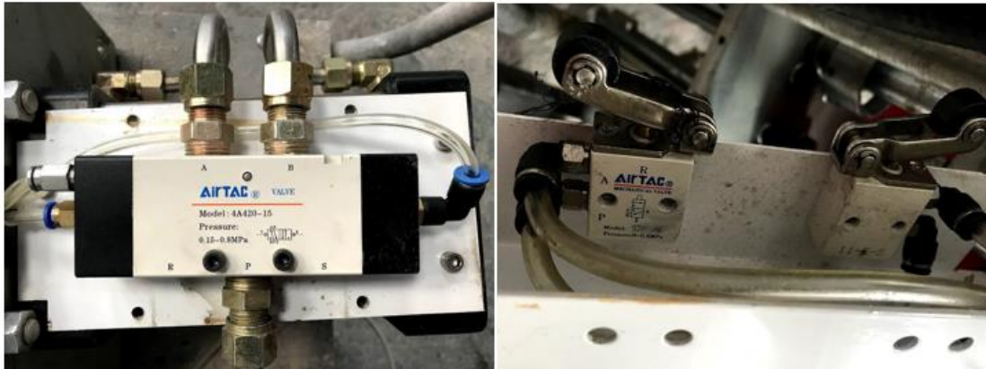
Figura 18-3. Electroválvula 5/2 y finales de carrera 3/2
