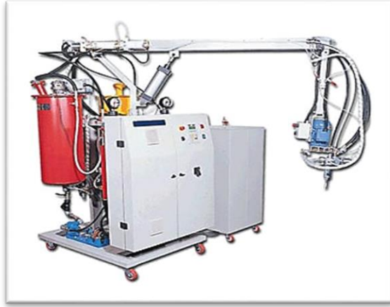
Figura 4-2. Inyectora de poliuretano completa o industrial
