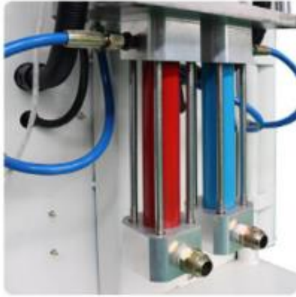
Figura 17-2. Bombas de aumento de presión
