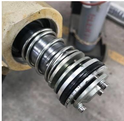
Figura 15-3. Lubricación de los resortes y empaques de los pistones
