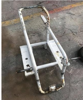
Figura 4-3. Lijado de la estructura metálica
