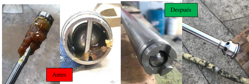
Figura 14-3. Mantenimiento de los ejes de succión
