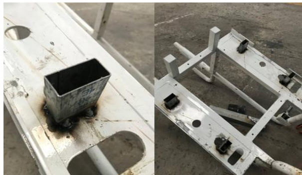
Figura 5-3. Soldado de los cuatro tubos para soporte
