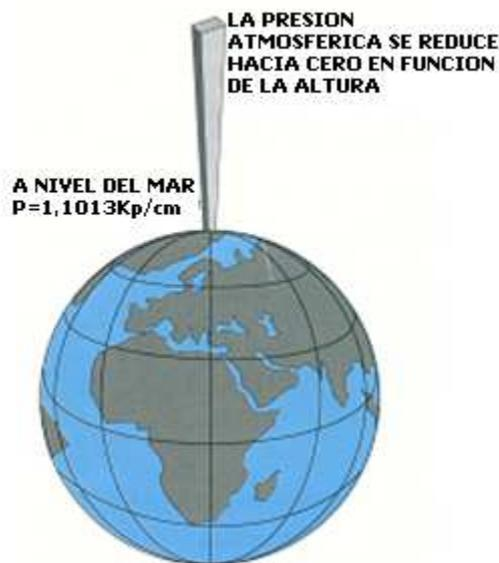
**Fig. (6)** Relación entre presión y altitud, International Training SMC, neumática
