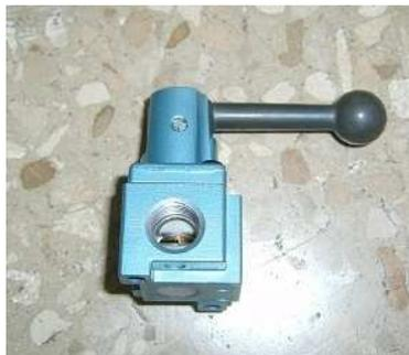
**Fig. (22)** Válvula distribuidora 3x2
