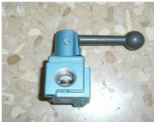
**Fig. (42)** Válvulas distribuidora 3x2
