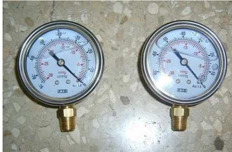
**Fig. (40)** Vacuómetros
