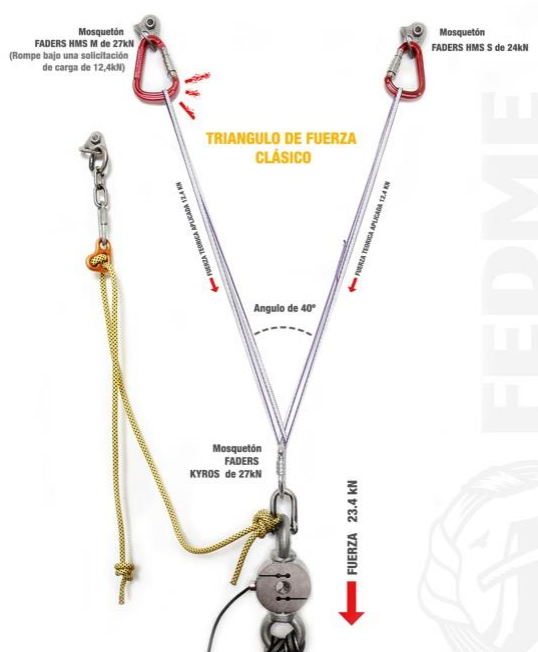
Figura 9.20. Estación de seguridad
