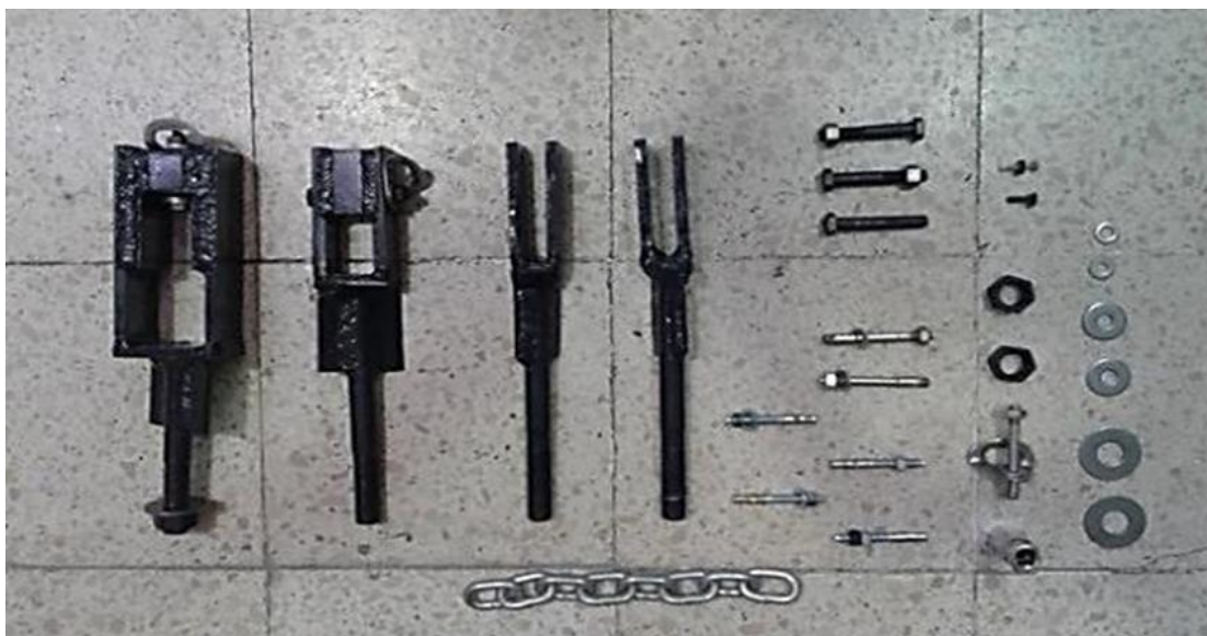
Figura 9.12. Mordazas adaptadas para prueba en la maquina universal de ensayos
