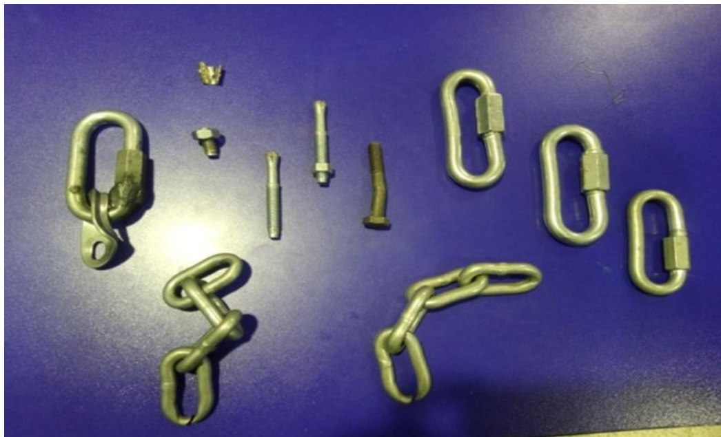
Figura 9.14. Material deformado después de ser sometidos a pruebas de resistencia
