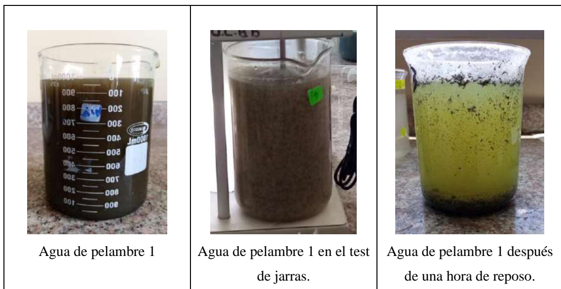
Figura 3-3: Agua de pelambre 1 con PAC, ensayo 1.
