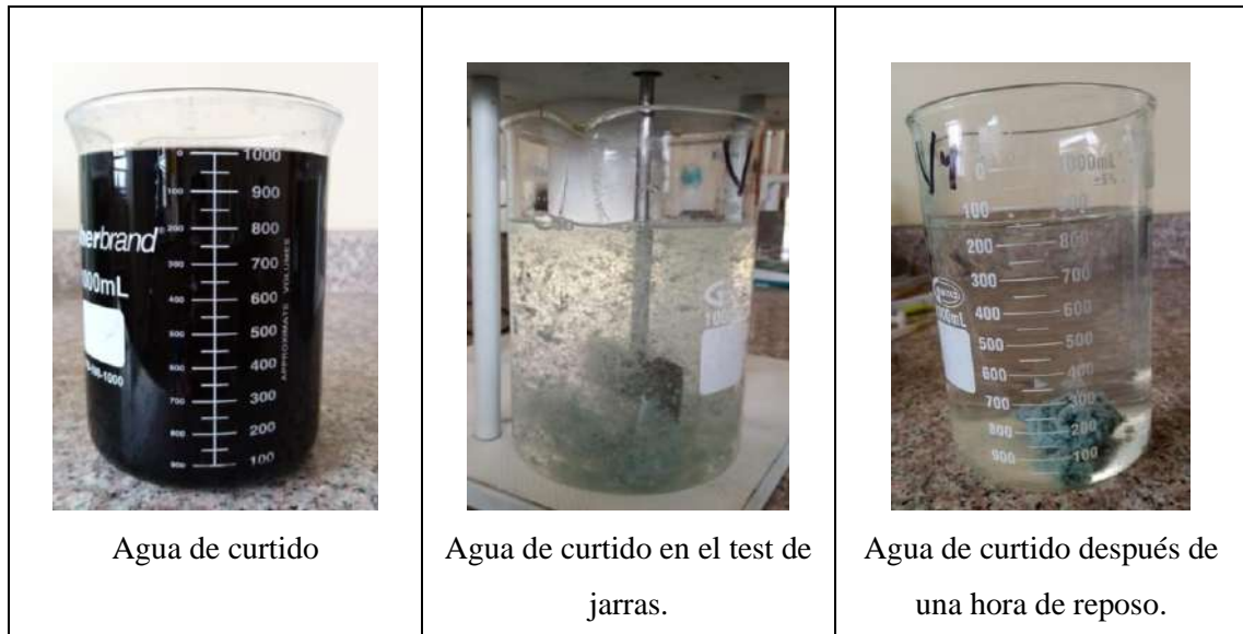
Figura 15-3: Agua de curtido con PAC, ensayo 13.
