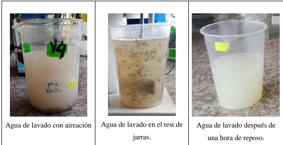
Figura 14-3: Agua de lavado con aireación y FeCl_3 , ensayo 12.
