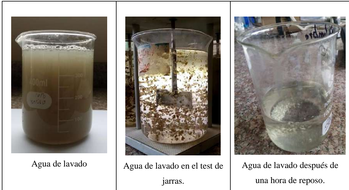
Figura 13-3: Agua de lavado con FeCl_3 , ensayo 11.
