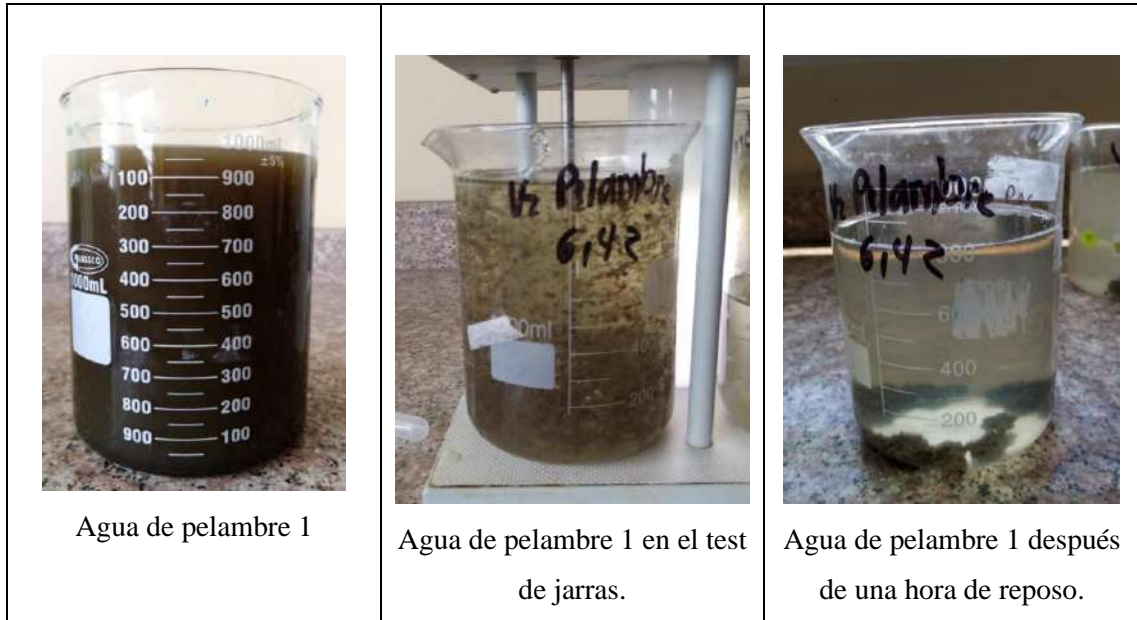
Figura 9-3: Agua de pelambre 1 con FeCl_3 , ensayo 7.
