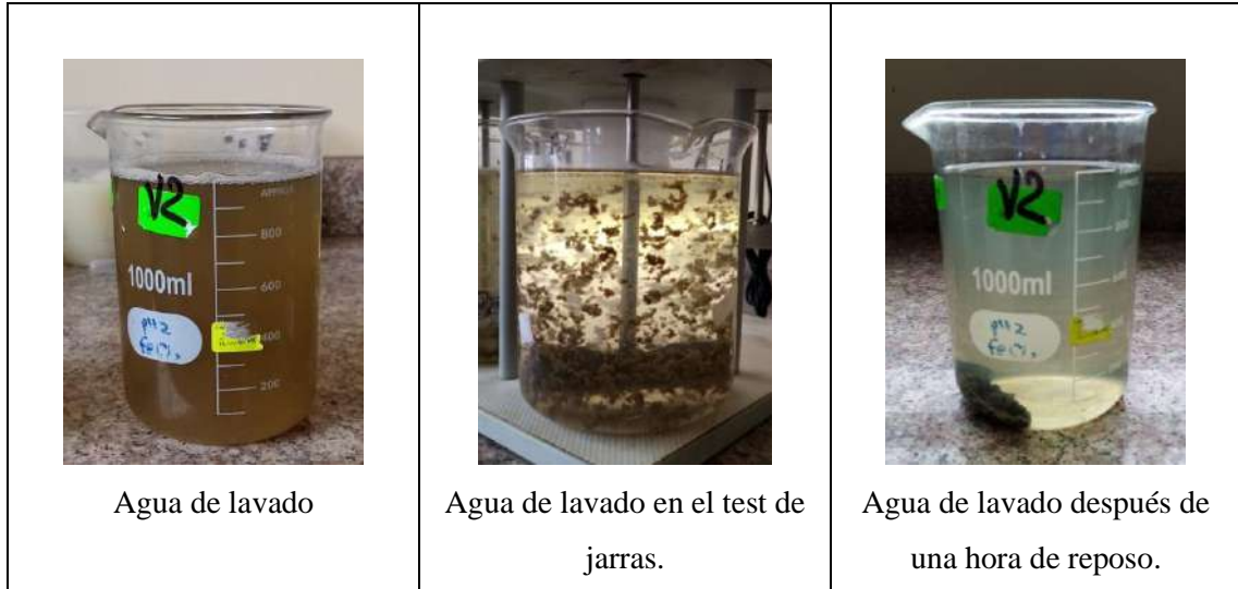
Figura 7-3: Agua de lavado con PAC, ensayo 5.
