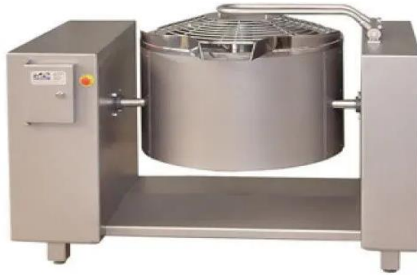
Figura 15-3: Freidora industrial de snacks a vapor. Realizado por: Maquinox JL, 2021.
