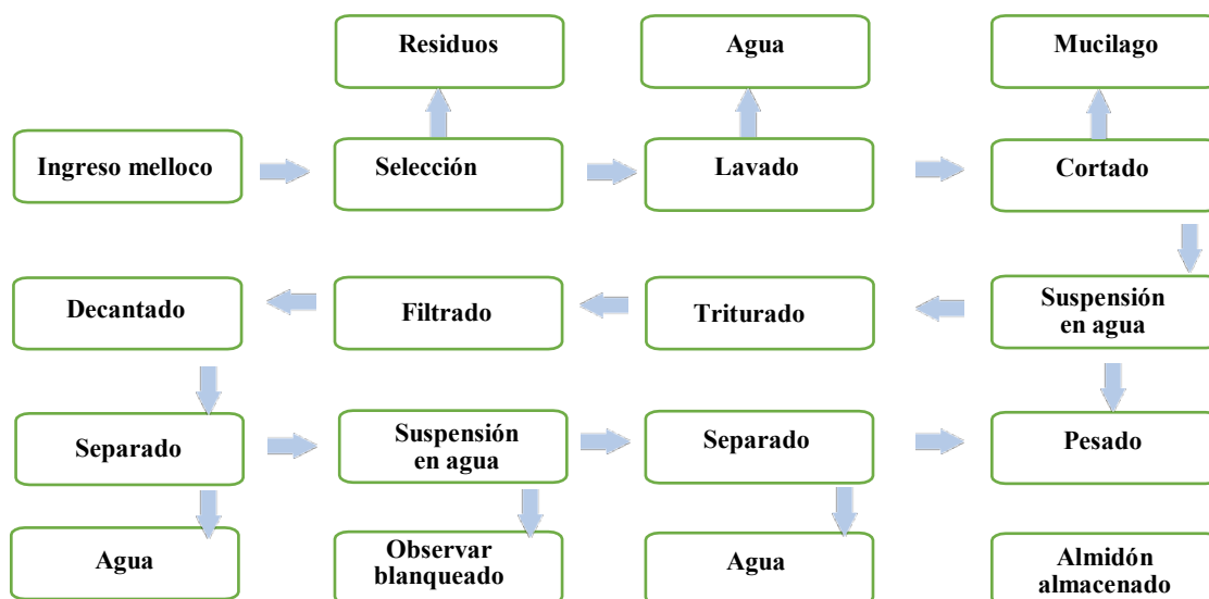
Gráfico 2-2: Diagrama de flujo de extracción de almidón por vía húmeda.
