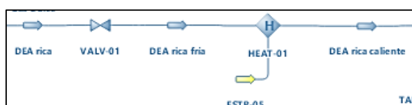
Figura 10-3. Etapas de despresurización isoentálpica y posterior calentamiento de la amina rica.
