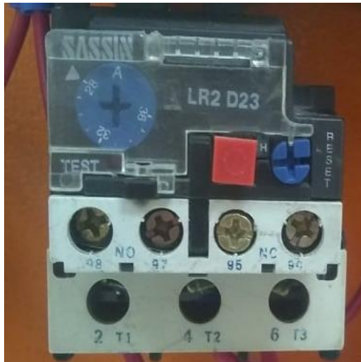
Figura 7-3: Relé térmico LR2 D23
