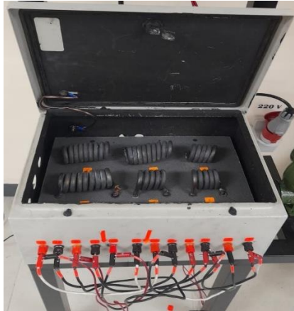
Figura 18-3: Montaje de resistencias en el módulo
