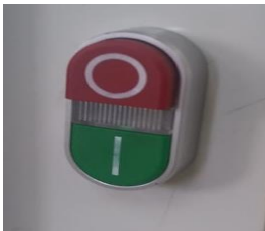
Figura 8-3: Pulsadores de inicio y arranque
