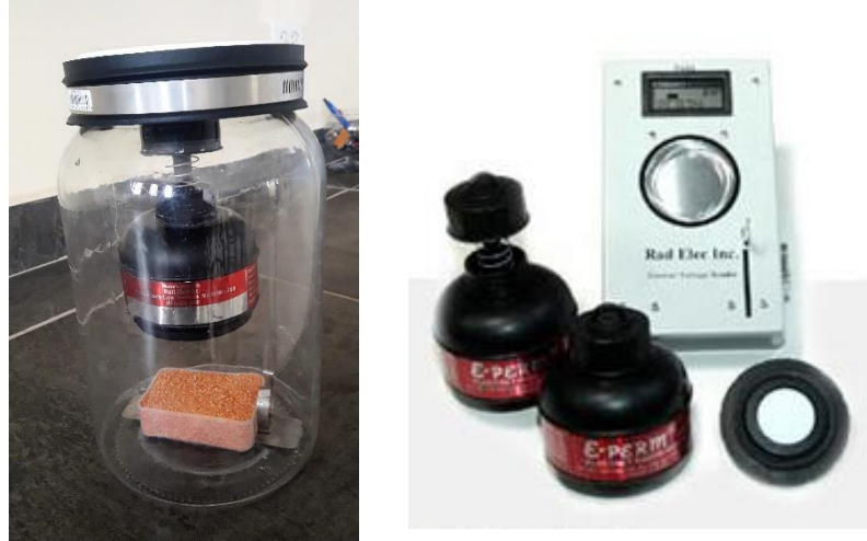
Figura 2-2. Sistema E-PERM para el análisis de la tasa de exhalación de radón de muestras de papa.
