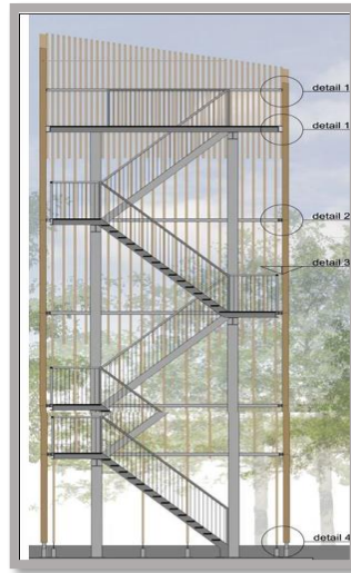
Figura 6-2. Diseño de construcción de torre de avistamiento
