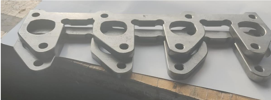
Figura 23-3: Soporte que une el sistema de escape al block del motor del vehículo Chevrolet corsa 1300 cc.
