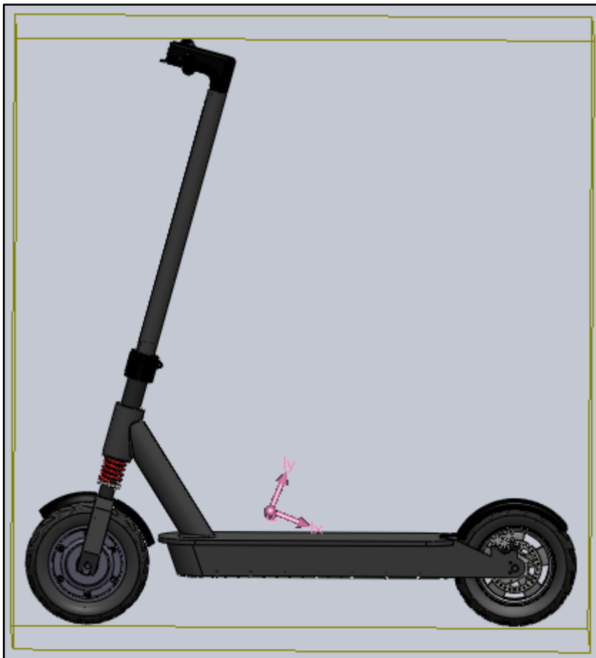
Figura 60-3. Centro de gravedad del scooter sin asiento.
