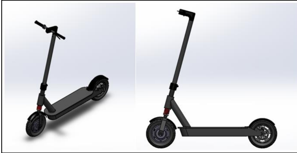
Figura 57-3. Scooter eléctrico final sin asiento.
