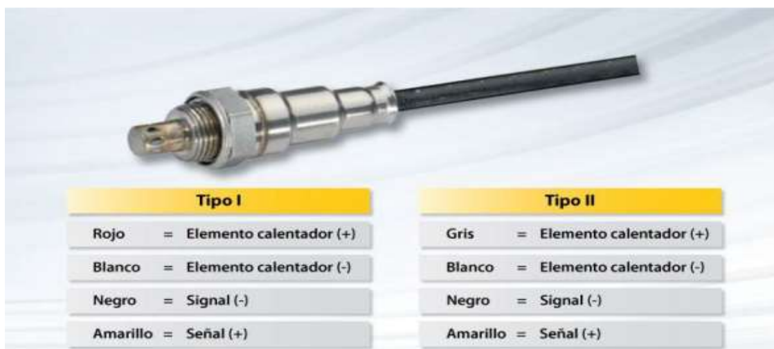
Figura 13-1. Asignación de cables para sondas lambda de dióxido de titanio
