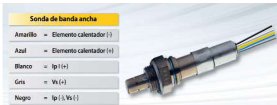
Figura 13-1. Asignación de cables para sondas lambda de banda ancha
