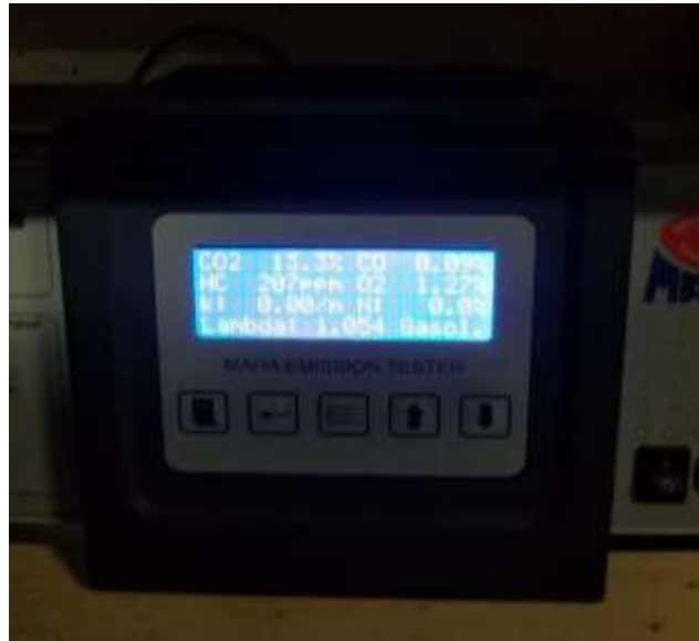
Figura 10-2. Analizador de gases previo a su utilización
