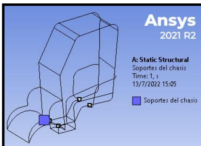
Figura 30-3: Soportes en el chasis
