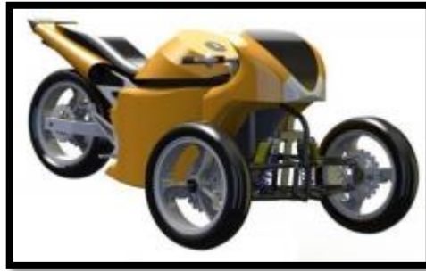
Figura 8-2: Mecanismo de dirección montada en un vehículo tri-moto
