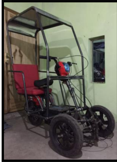
Figura 9-4: Ensamble total de monoplaza eléctrico
