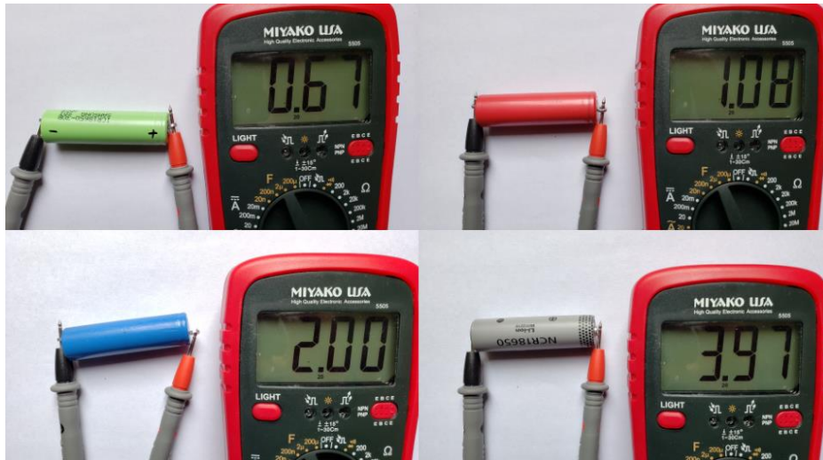
Figura 14-3: Medición del estado de carga de las celdas.
