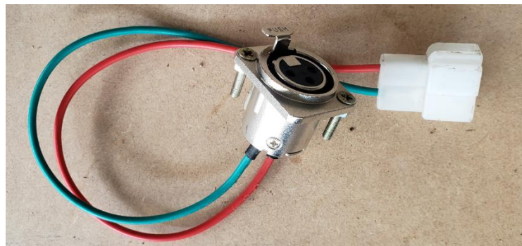
Figura 37-3: Modificación del conector de carga
