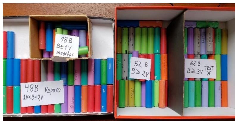
Figura 15-3: Clasificación de celdas según su voltaje.
