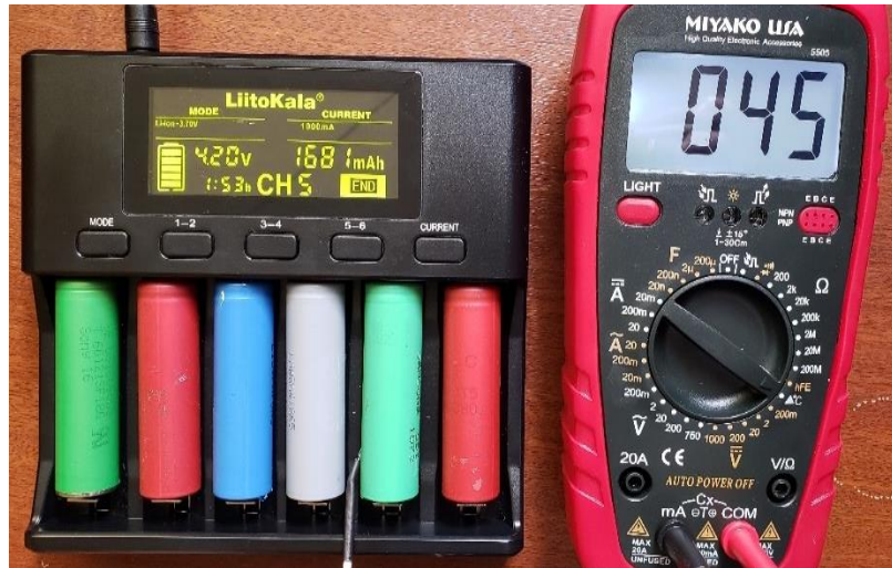
Figura 16-3: Monitoreo de temperatura de carga con termocupla ( ^{\circ}\text{C} ).
