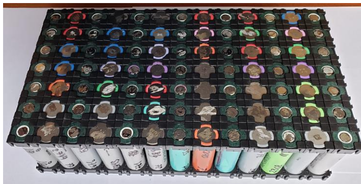
Figura 25-3: Configuración en serie y paralelo de la batería
