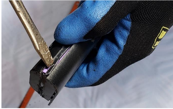
Figura 9-3: Desmontaje de las baterías de laptops.
