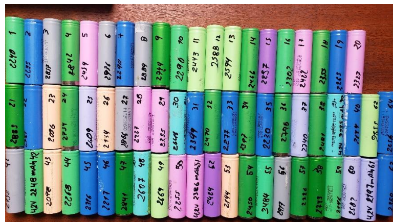
Figura 18-3: Marca de capacidad de descarga real de las celdas
