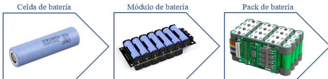
Figura 7-2: Niveles que compone un paquete de batería
