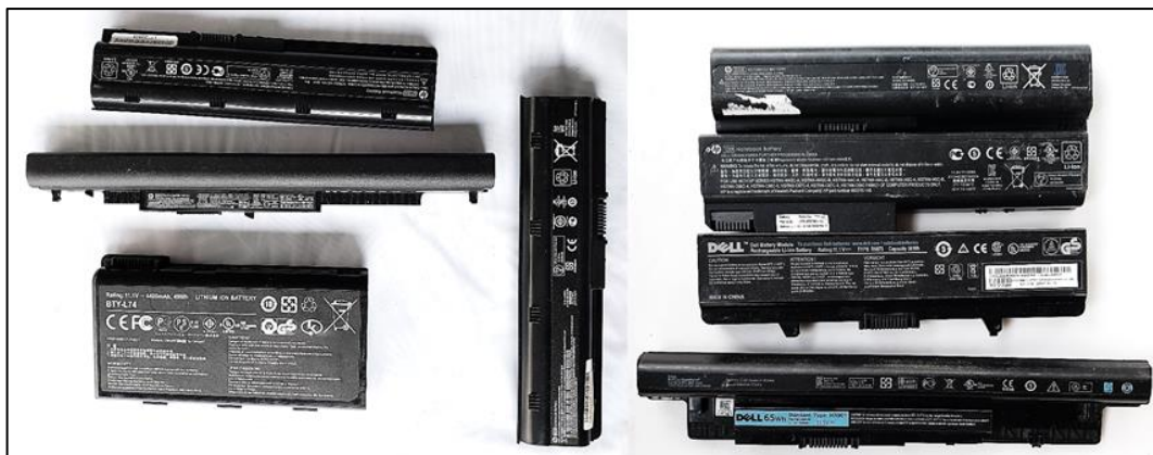
Figura 8-3: Modelos de baterías que contienen celdas Li-ion 18650.
