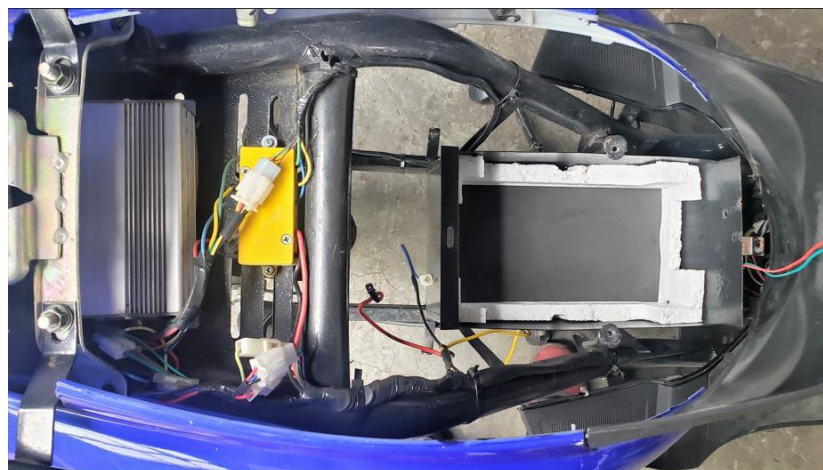
Figura 39-3: Reconexión de nuevos cables y terminales para la batería
