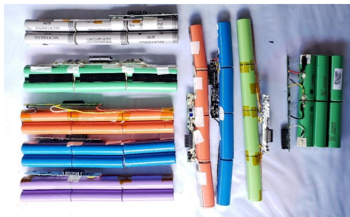
Figura 11-3: Extracción del conjunto de celdas.
