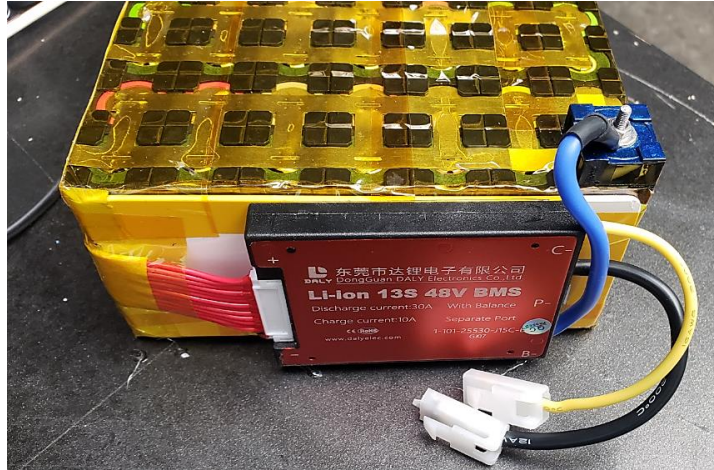
Figura 30-3: Conexión del BMS a la batería
