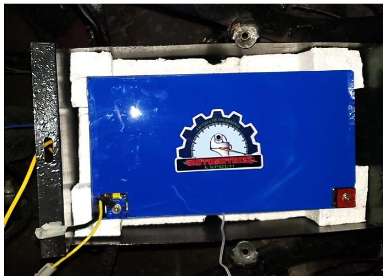
Figura 35-3: Integración de la batería en la base de la motoneta
