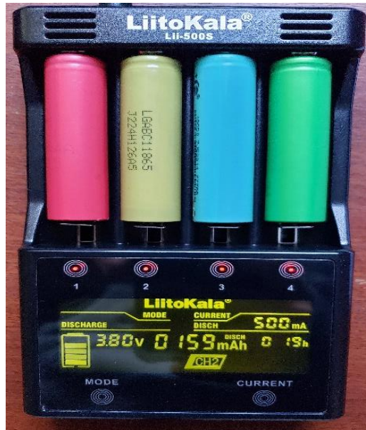
Figura 17-3: Proceso de descarga a 500 mA
