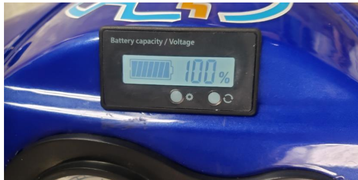
Figura 38-3: Adaptación del indicador de estado de la batería
