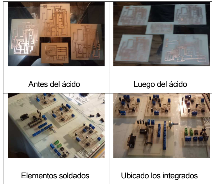
Figura V.61: Construcción de las Tarjetas de Adquisición
