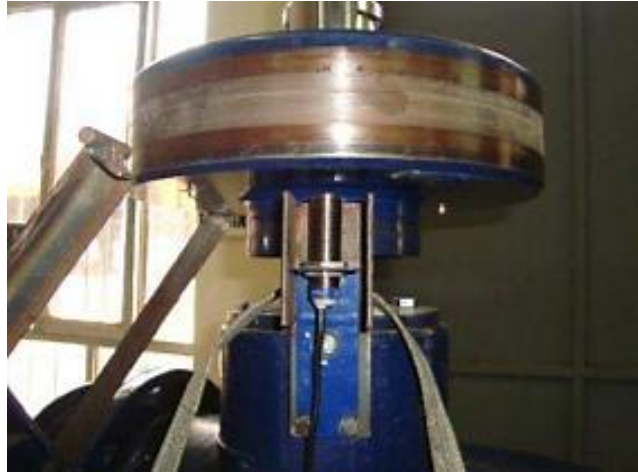
Figura 8-3: Sensor de proximidad en el tambor de freno
