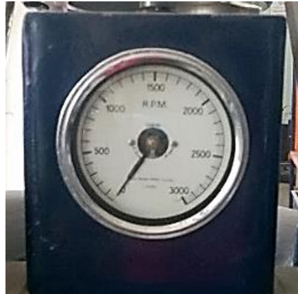
Figura 4-1: Tacómetro de la turbina
