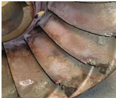
Figura 18-2: Cavitación en los álabes
