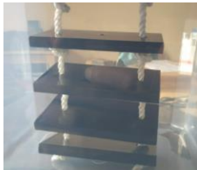
Figura 10-3: Soporte de las placas testigos.
