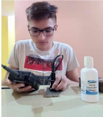
Figura 7-3: Medición de espesor por ultrasonido a placas testigos
