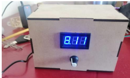
Figura 4-2: Regulador de voltaje
