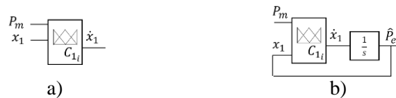
Figura 12-2: a) Estructura del sistema de inferencia difuso para predecir la derivada primera de la potencia eléctrica b) Modelo diferencial neurodifuso del generador.
