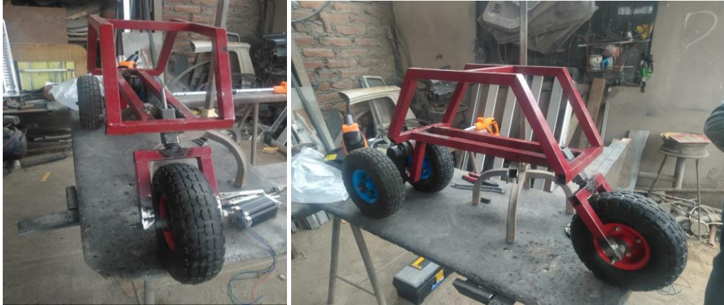
Figura 17-3: Estructura base con sistema de dirección y tren trasero. Realizado por: Villacis, A. 2021
