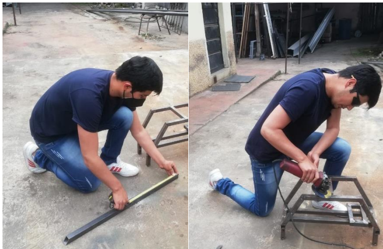
Figura 16-3: Construcción de la estructura base
