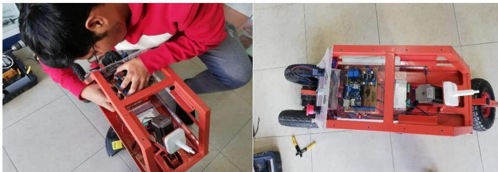
Figura 21-3: Colocación de la Placa de Control AUTOPRO en el prototipo Realizado por: Villacis, A. 2021
