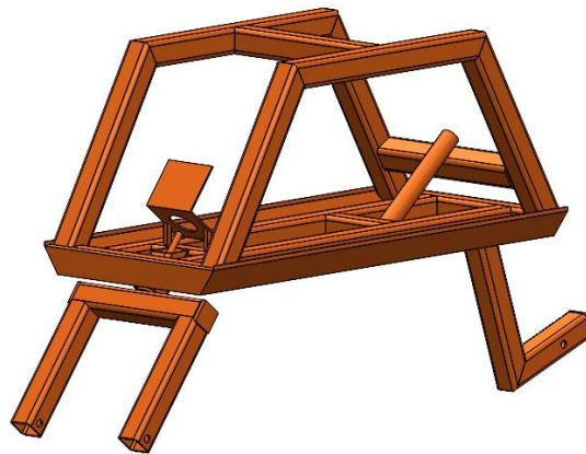
Figura 7-3: Ensamble triciclo clásico Realizado por: Villacis, A. 2021
