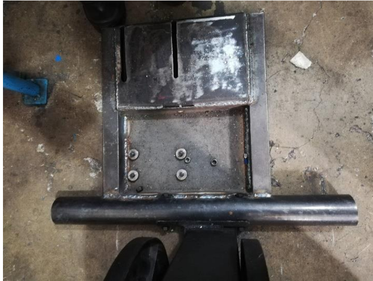
Figura 52-3: Elaboración de soporte para motor y reductor
