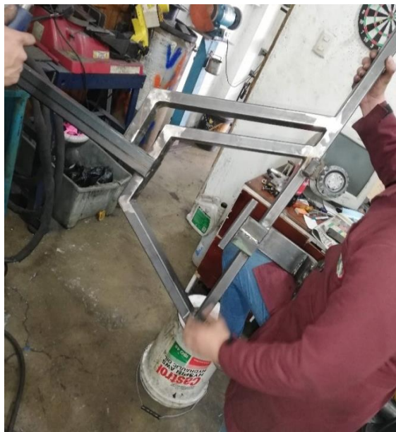
Figura 51-3: Elaboración de acople superior para motor de arnés
