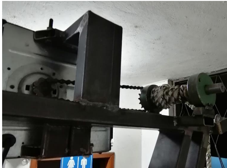
Figura 55-3: Mecanismo cadena – piñón para motor de arnés
