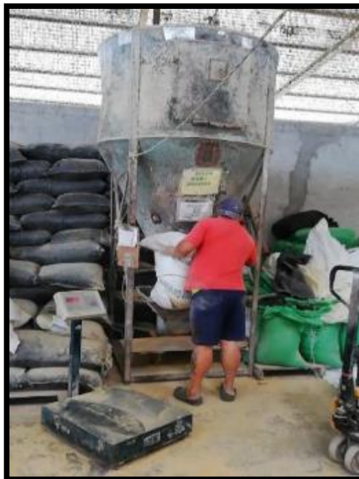
Figura 6-4: Agregado de macroelementos a la tolva
