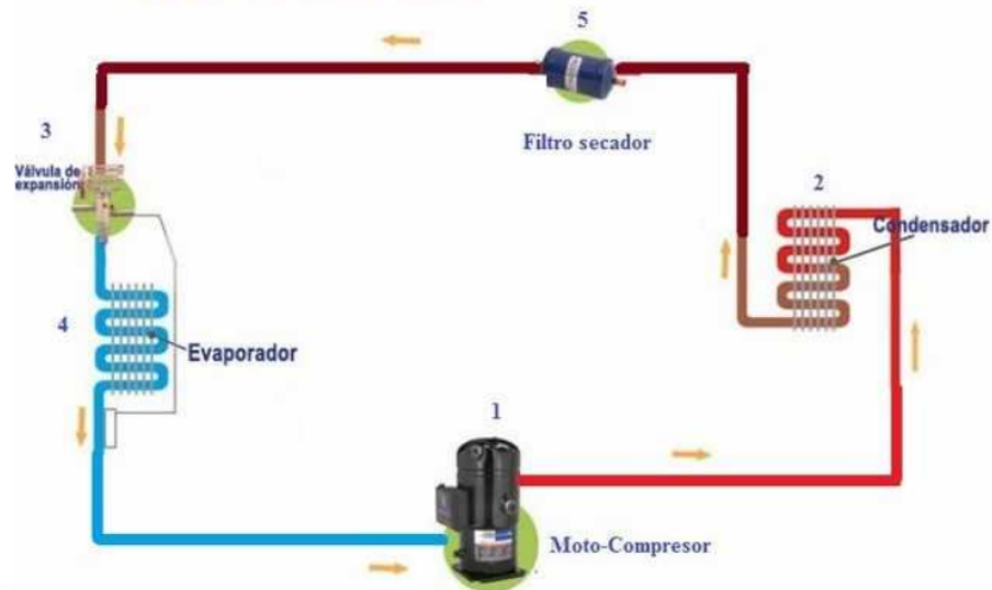
Figura 4-1: Esquema circuito frigorífico
