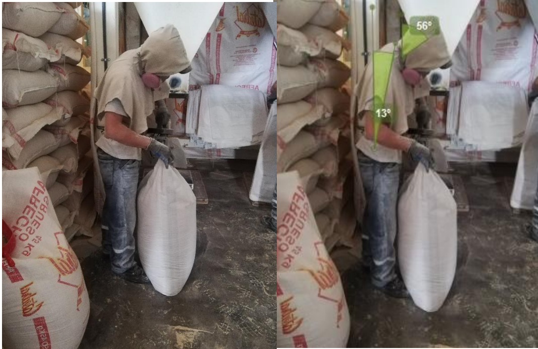
Figura 8-4: Ángulos de evaluación ergonómica grupo B del puesto de cosido del trabajador 2
