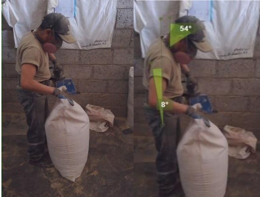
Figura 6-4: Ángulos de evaluación ergonómica grupo B del puesto de cosido del trabajador 1
