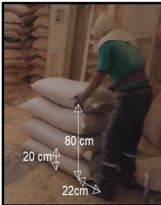
Figura 12-4: Medidas de evaluación ergonómica en el puesto de trabajo de carga hacia la sección de mezcla y molido.
