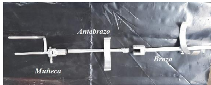
Figura 16-3: Partes fabricadas del prototipo de rehabilitación. Realizado por: Arteaga David, Garcés Dennis, 2021
