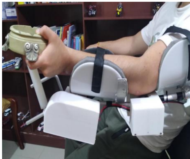
Figura 23-3: Pruebas con carga adicional de 650gr Realizado por: Arteaga David, Garcés Dennis, 2021
