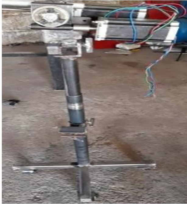
Figura 17-3: Eje metálico principal del prototipo Realizado por: Arteaga David, Garcés Dennis, 2021
