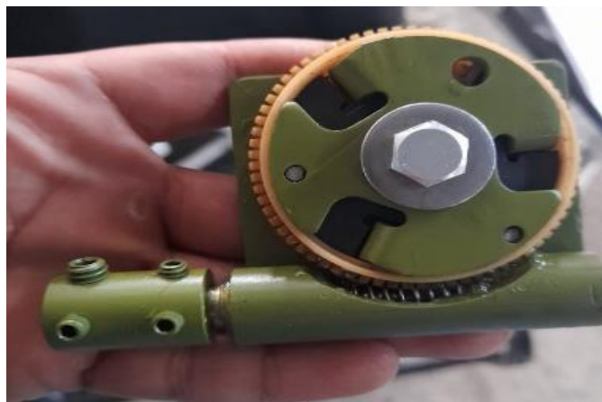
Figura 14-3: Motor reductor formado por piñón y sinfín Realizado por: Arteaga David, Garcés Dennis, 2021
