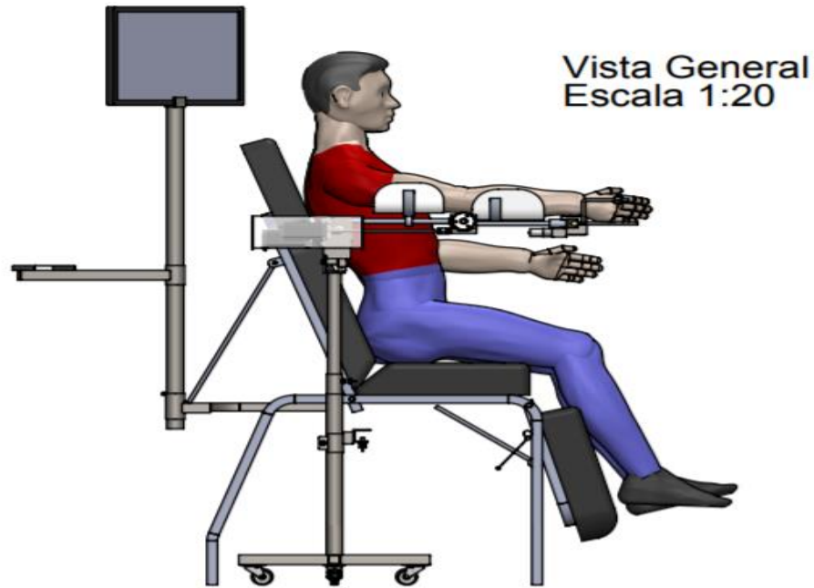
Figura 3-4: Diseño Prototipo mecánico final Realizado por: Arteaga David, Garcés Dennis, 2021
