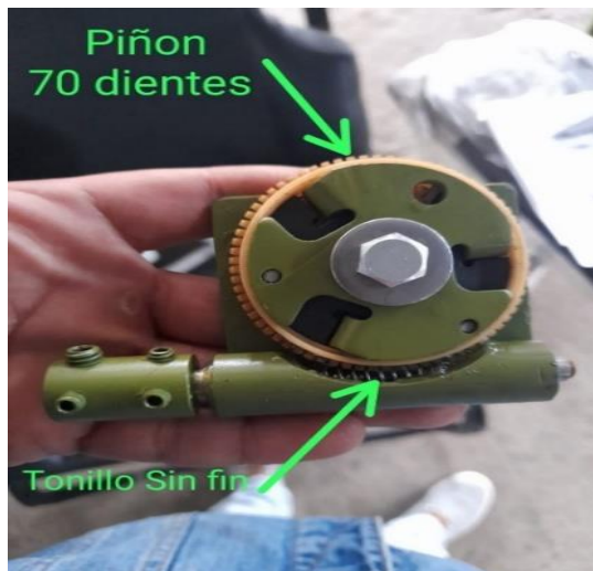
Figura 9-3: Partes de la caja reductora Realizado por: Arteaga David, Garcés Dennis, 2021
