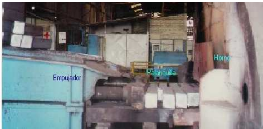
Figura N° 10.- Ubicación de la palanquilla en la puerta del horno.
