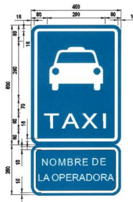
Figura 2-1. Señalización taxis vertical
