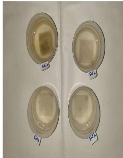
Biodegradación del bioplástico en agua.
