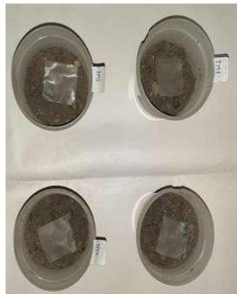
Biodegradación del bioplástico en tierra
