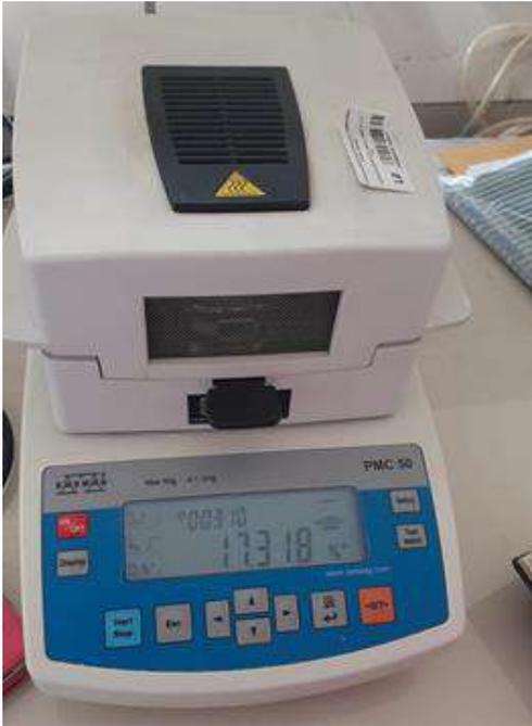
Determinación de humedad del bioplástico
