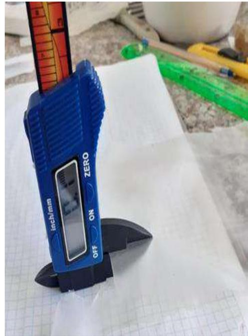
Medición de espesor
