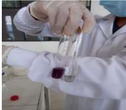
Ensayo de identificación y solubilidad de salicilato de metilo
