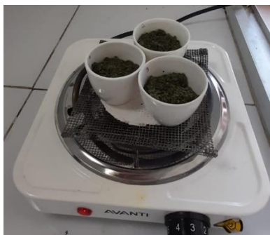
Determinación de humedad, cenizas totales, solubles en agua e insolubles en HCl.
