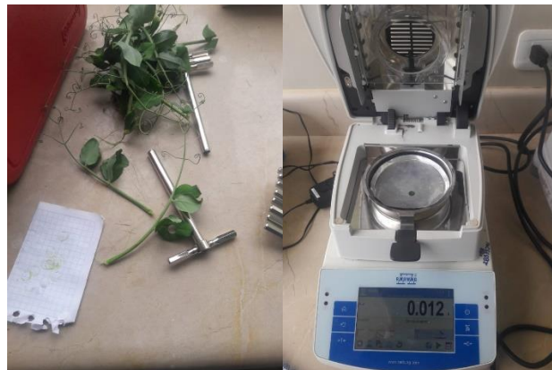
Figura 13-2. Toma de muestra con el sacabocado y peso.
