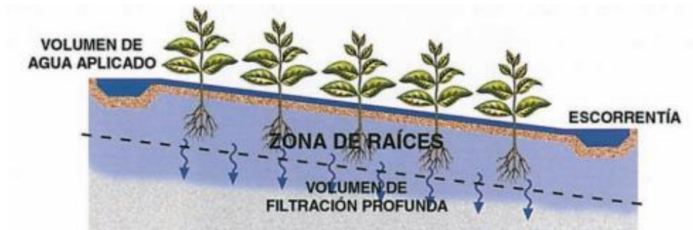
Figura 1-2. Eficiencia de riego por gravedad.
