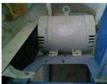
**Figura 68: Pernos de sujeción del motor**
