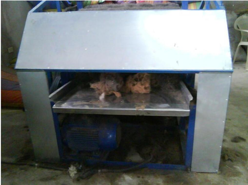
**Figura 45: Motor del cardador**
