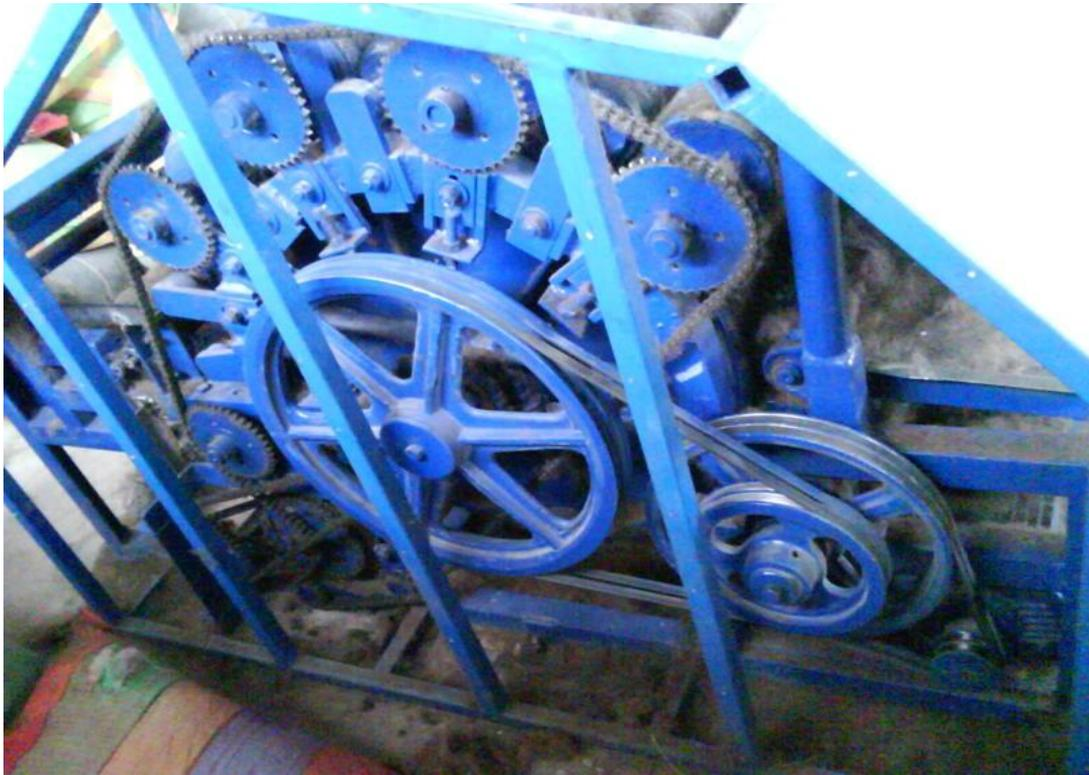
**Figura 47: Sistema de transmisión de potencia del cardador**
